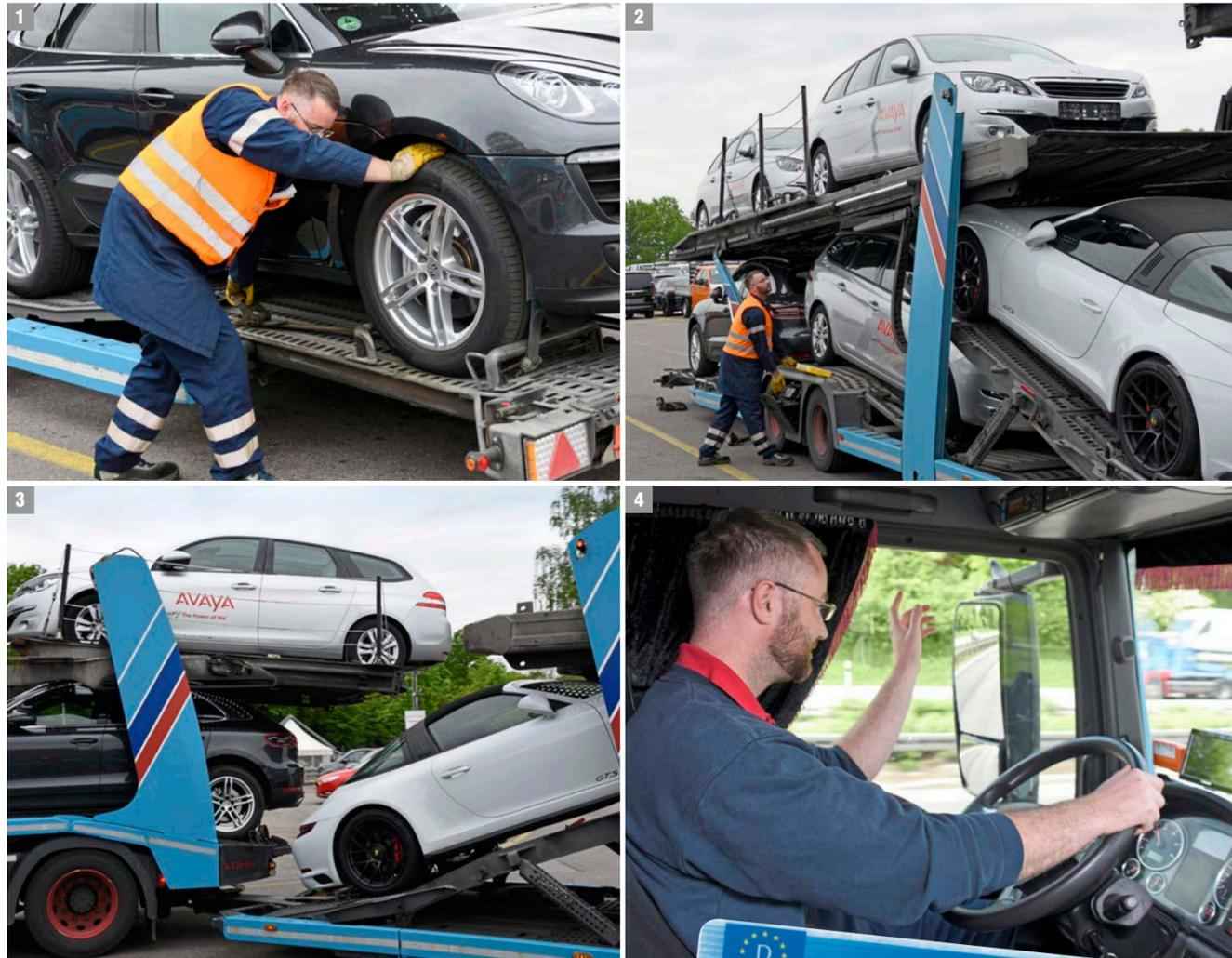
**1 DIE LADUNGSSICHERUNG** auf einem Autotransporter ist genau vorgeschrieben, hier sind es zwei Keile und ein Gurt um die Vorderachse.
