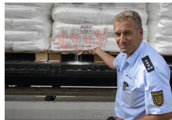
Hier rieselt pulverförmiges Gefahrgut aus einer beschädigten Verpackung.
