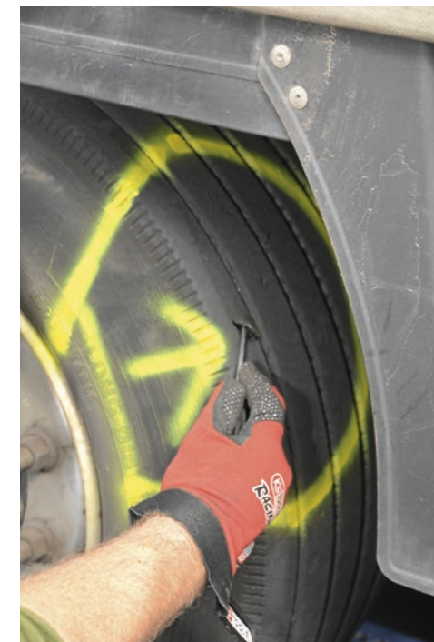
Dieser Lkw wird wegen eines Reifenschadens stillgelegt.
