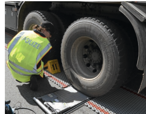
Per Achswaage kontrollieren die Beamten, ob die Lkw überladen sind.
