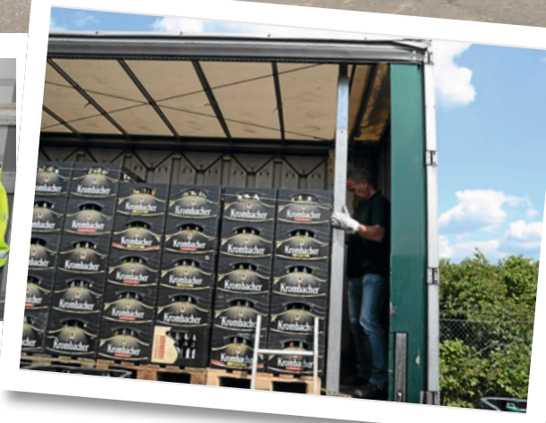
Klappbare Steckbretter an der rechten Seite des Aufliegers dienen der Formschlüssigkeit.
