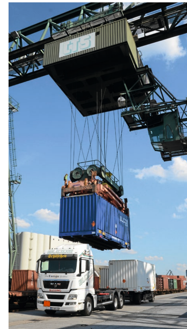
Der Terminalkran im Niehler Hafen hebt die Brücken vom Lkw.
