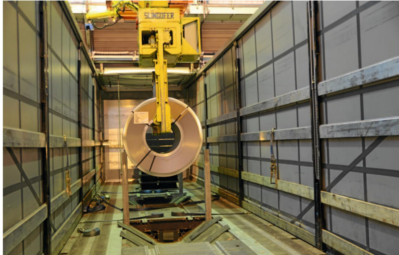
Per Kran werden die tonnenschweren Coils in die Mulden des Aufliegers gehievt.
