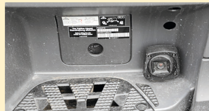
Eine kleine Weitwinkelkamera ist fest auf der untersten rechten Trittsstufe verbaut und liefert permanent Bilder in die Kabine.
