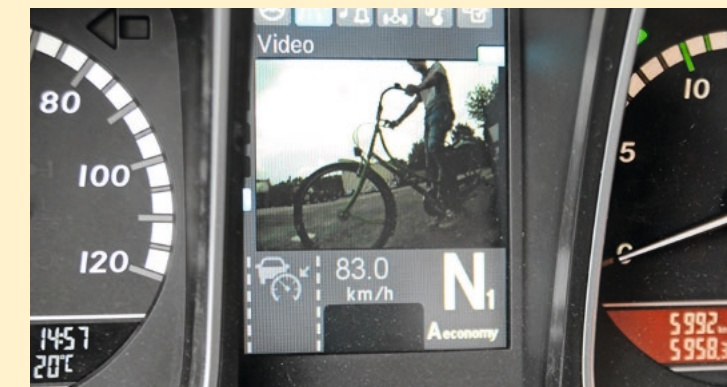
Der Fahrer sieht beim Blick auf das zentrale Armaturenbrett, ob sich möglicherweise ein Radfahrer im toten Winkel aufhält.
