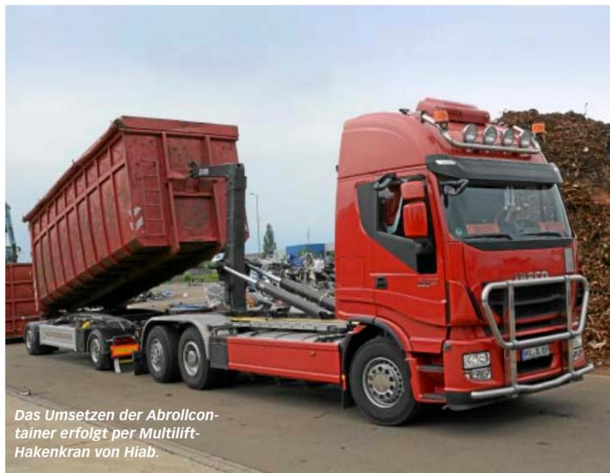
Das Umsetzen der Abrollcontainer erfolgt per Multilift-Hakenkran von Hiab.
