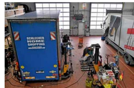
Die Werkstatt am Standort Mellendorf verfügt über einen Bremsenprüfstand.
