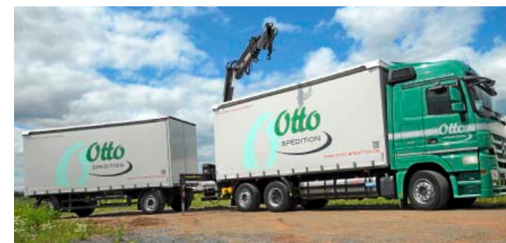
Zwei Hängerzüge besitzen funkferngesteuerte Ladekräne.
