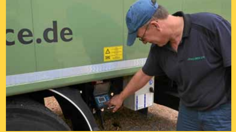
Eine Waage am Heck des Aufliegers ermöglicht das korrekte Beladen im Feld.
