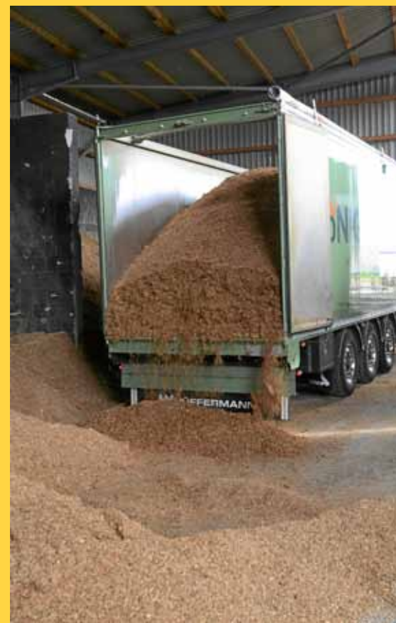
Rund 24 Tonnen gegorene Maismasse fallen automatisch aus dem Auflieger.
